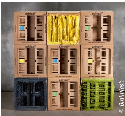
Gesättigte und ungesättigte Farbnebelabscheider im Vergleich
