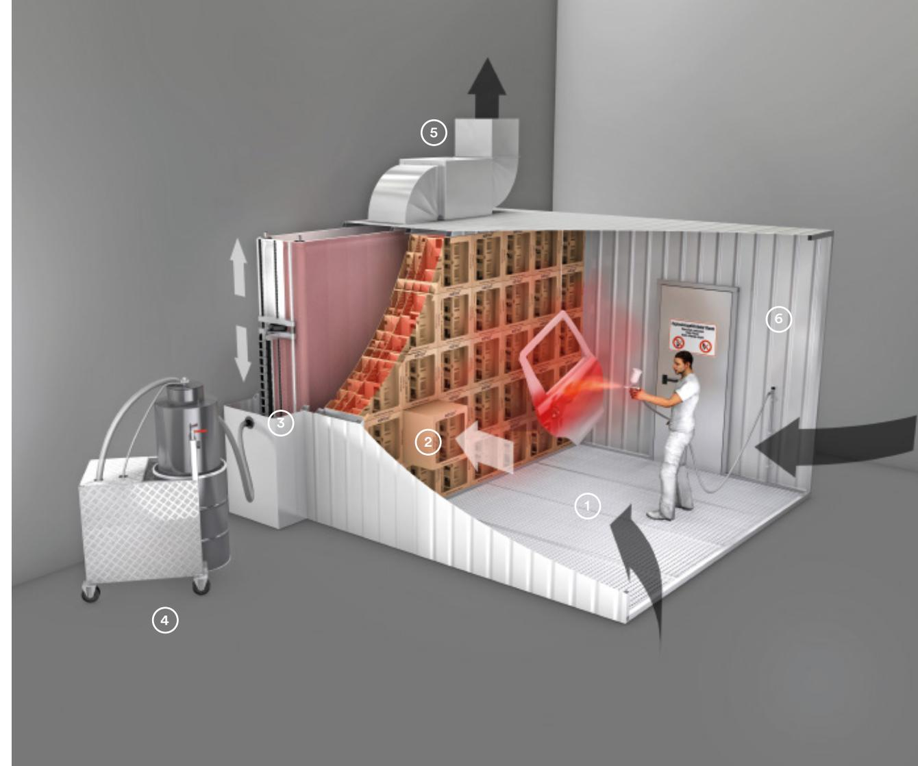
Il sistema edrizzi® con filtraggio circolante è costituito da una struttura in lamiera d'acciaio zincata con separatori Vario edrizzi® e una cassa di aspirazione, una stuoia filtrante a circolazione infinita, il sistema di propulsione e un'unità di aspirazione.
