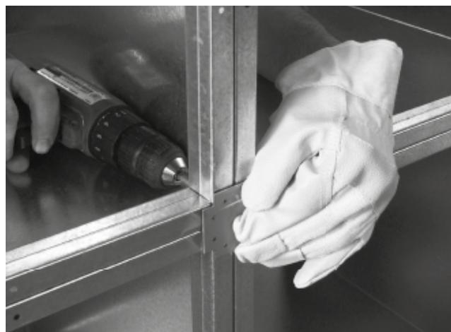
Le scatole edrizzi® possono essere facilmente e rapidamente combinate con questi elementi, a seconda dell'incremento dimensionale, a creare una parete di separazione di qualsiasi dimensione.
