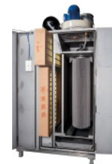
L'accesso laterale è ideale per sostituire il filtro secondario indipendentemente dai separatori di nebbia di verniciatura. In questo sistema di presentazione presso il laboratorio edrizzi® è stato inoltre utilizzato un sistema di pulizia della cartuccia completamente automatico come ulteriore filtro secondario.
