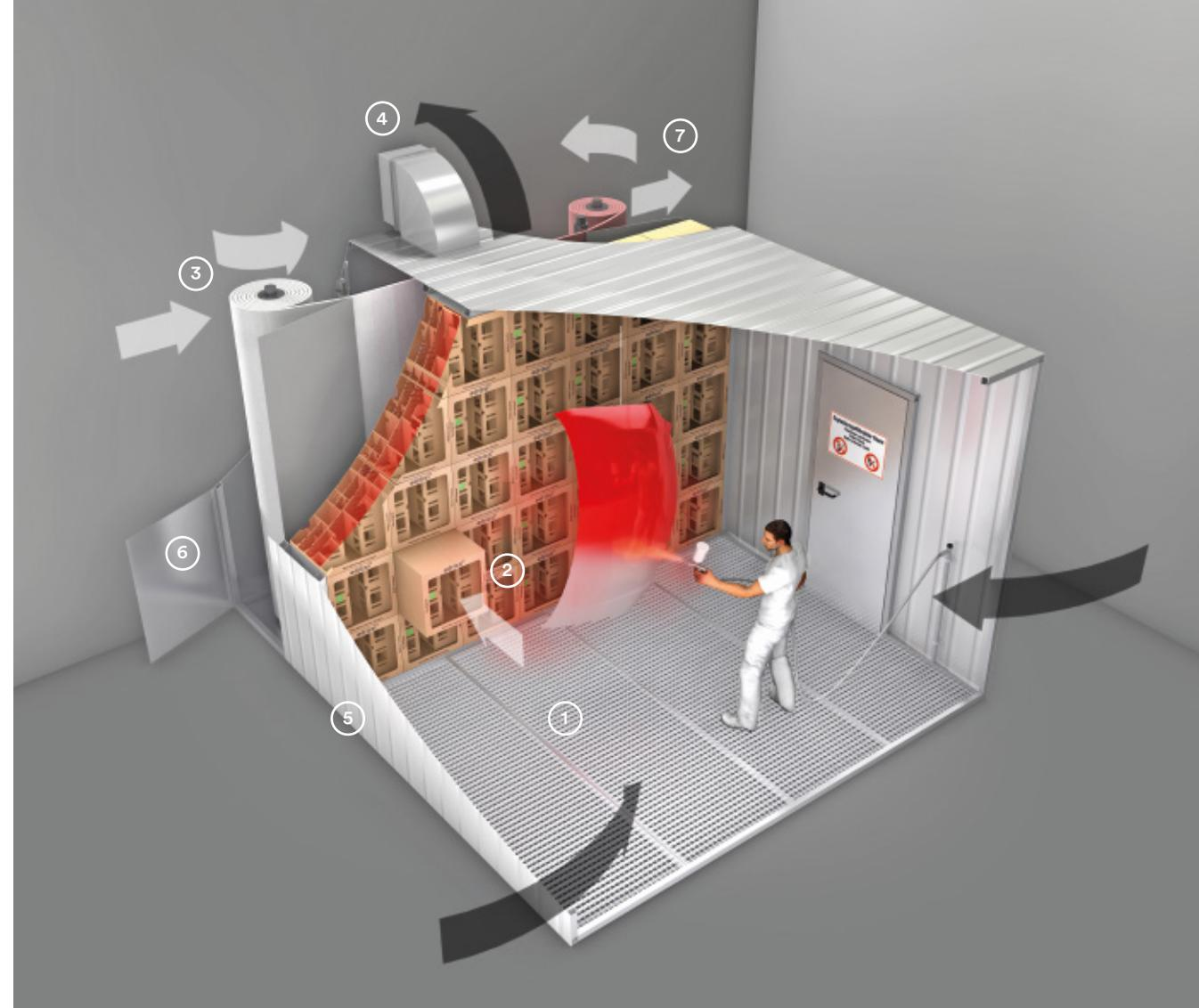
Il sistema edrizzi® con ABRO consiste di una struttura in lamiera d'acciaio zincata con separatori Vario edrizzi® e cassa di aspirazione, stuoia filtrante secondaria e il sistema di azionamento.
