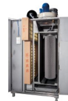
L'accès latéral est optimal pour pouvoir changer le filtre secondaire indépendamment du séparateur de brouillard de vernis.
