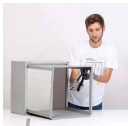
Step3: Deckel wird eingeschoben und mit Nieten am oberen Ende eines Winkels fixiert.
