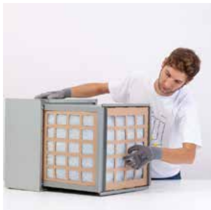
Step7: Cube in Halterahmen einschieben und Verschlussleiste fixieren.
