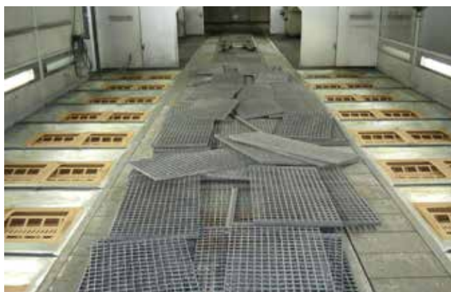
Beispiel Unterfluranwendung - Abbildung: Die Blechwannen oder Blechschielen sind Sonderanfertigungen des Herstellers oder des jeweiligen Anlagenbauers und können für jede Type verwendet werden.
