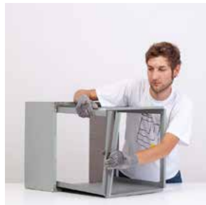
Step2: Winkel werden mit Nieten am Boden fixiert.
