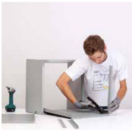
Step2: Winkel werden mit Nieten am Boden fixiert.
