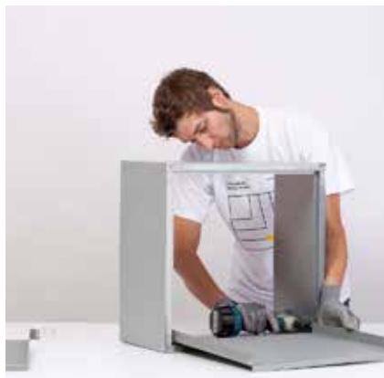
Step1: Boden wird eingelegt und mit Selbstbohrschrauben von innen nach außen verbunden.
