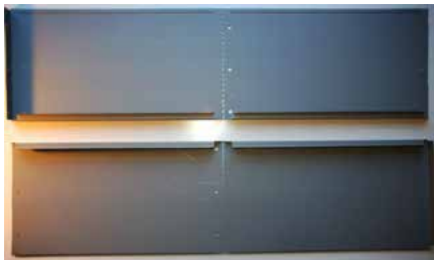
Die vorgestanzten, unterschiedlichen Seitenwände
