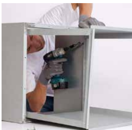
Step4: Deckel wird mit Selbstbohrschrauben mit dem Einschubelement verschraubt.
