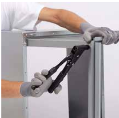
Step6: Erst jetzt wird der letzte Winkel vernietet.
