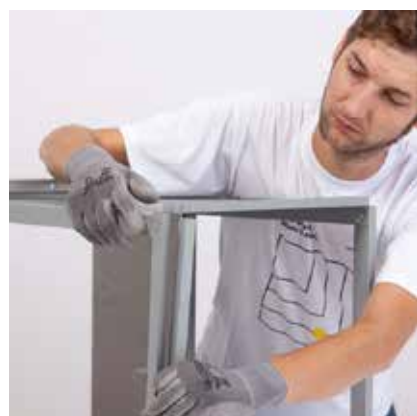
Step5: Achtung: Bevor der letzte Winkel vernietet wird, Verschlussleiste rückseitig oben und unten in die vorgesehenen Löcher einhängen.
