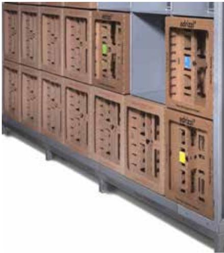
Einschubelemente immer auf einem Sockel aufbauen, um den Wechsel der Farbnebelabscheider in der untersten Reihe zu gewährleisten.
