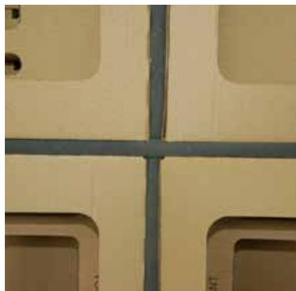
Abbildungen: Rechts Schaumgummiband und links gewöhnliches Klebeband werden zum Abdichten der Farbnebelabscheider verwendet.
