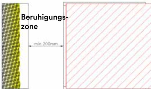
Nachfilterung NFEWP02 und NFEWP03: In der Konstruktion werden mindestens 200mm Luftberuhigungszone eingeplant.
