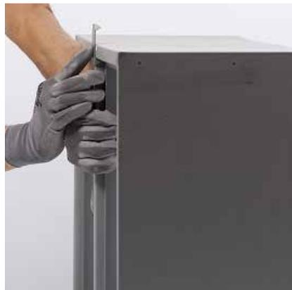
**Step3:** Die Einschubelemente von innen nach außen mit dem Knotenblech zusammenfügen und verschrauben.
