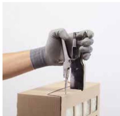
Die Filtermedien können bei Bedarf mit einer Heftzange oder ähnlichem fixiert werden, um deren Ver-rutschen bei schwerem Overspray zu vermeiden.
