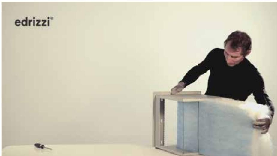
**Step1:** Zum Einsetzen des Filtermediums dieses genau in der Mitte falten und mit der Farbe nach innen durch die Bügel in den Rahmen ziehen.
