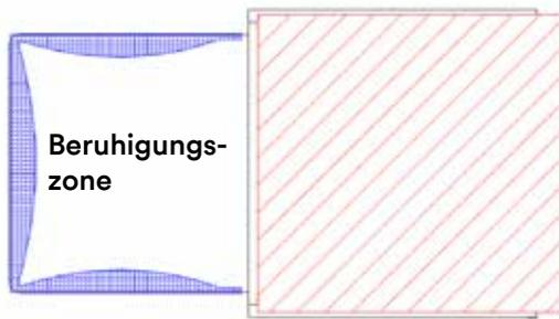
Nachfilterung CUBE01 mit optimal integrierter Beruhigungszone: 400mm Luftberuhigungszone in einer Kammer.
