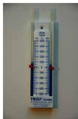
Beispiel für eine Differenzdruckmessung: U-Rohr Manometer
