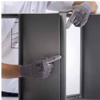
**Step2:** Beginnen Sie mit dem horizontalen Aufbau. Auf die Fälze an der Vorderseite achten. Mit der „laschenlosen“ Seite des nächsten Einschubelementes zusammenschieben.
