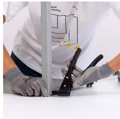
Als erstes werden die Winkel am Boden des Halterahmens mit Nieten fixiert.
