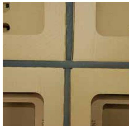
Schaumgummiband zum Abdichten der Farbnebelabscheider ist optimal, wenn sie einzeln ausgetauscht werden.
