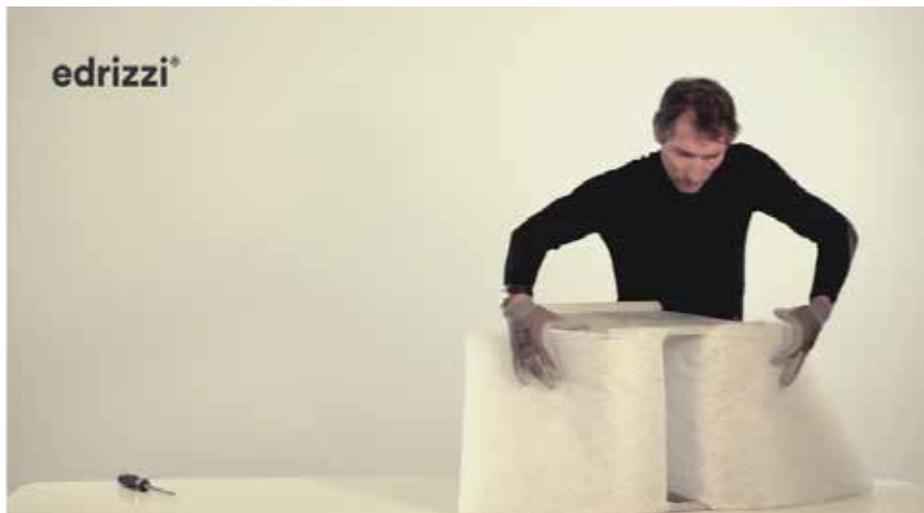
**Step2:** Das Filtermedium wird mit der farbigen Seite nach innen über die Außenkanten des Rahmens verkleidet.
