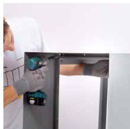
**Step3:** Der fertige Rahmen wird von vorne durch das entsprechende Einschubelement geschoben und dann mit Selbstbohrschrauben fixiert.
