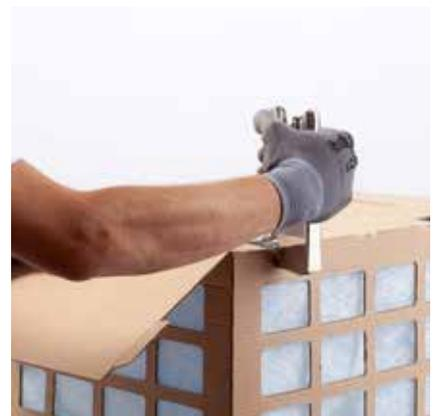
Step3: Das Filtermedium wird mit Tacker fixiert, die Laschen auf der Oberseite werden zur Stabilität eingerastet, der Karton wird geschlossen. Der fertig vorbereitete Karton wird in den Halterahmen geschoben.
