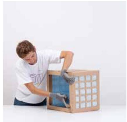
Step2: Das Filtermedium wird eingesetzt: Farbige Seite nach innen, genaues Einpassen in den Karton.
