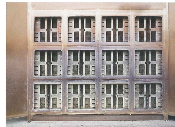
Eine Wand aus „Edrizzi“ funktioniert wie der Dunstabzug in der Küche. Die Luft wird eingesaugt, die Lackpartikel bleiben in der Pappe hängen.
