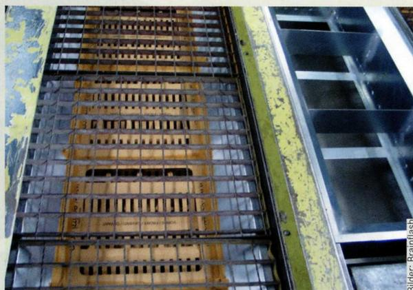
Die Trockenabscheidung wird mit vorgefertigten Blechauffangsystemen eingebaut, die bei einem Umbau nur eingehängt werden
