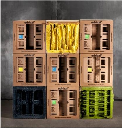
Gesättigte und ungesättigte Farbnebelabscheider im Vergleich. Lackkuchen auf der Vorderseite bedeutet allerdings noch lange nicht Sättigung, da der Großteil der Aufnahme im ersten Drittel der Boxen erfolgt und die Tiefen zur Erreichung des Abscheidegrades dienen. Zur einfachen Kontrolle wird bei laufender Anlage ein Blatt Papier an die Eintrittsöffnung gehalten. Wenn durch die Absaugung das Blatt festgehalten wird, sind die Boxen noch funktionstüchtig.
