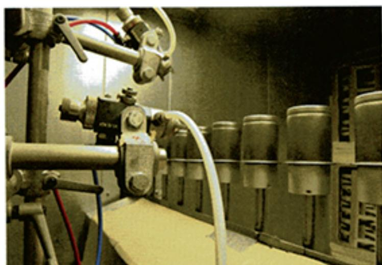
Das wasserbasierte Lacksystem wird mit „Optima ATM IV“-Spritzpistolen in LVLP-Ausführung appliziert.
