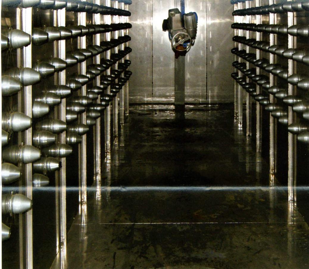
Die Durchlaufreinigungsanlage ist als 7-Zonen-Spritzvorbehandlungs-Taktanlage ausgelegt. Quelle: Dete
