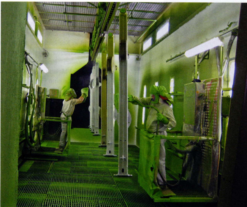
Bei dem Landtechnik-Unternehmen Claas Saulgau hat sich die Umstellung von Venturi-Nassauswaschung auf ein Abscheidesystem mit Trockenfiltern bewährt
